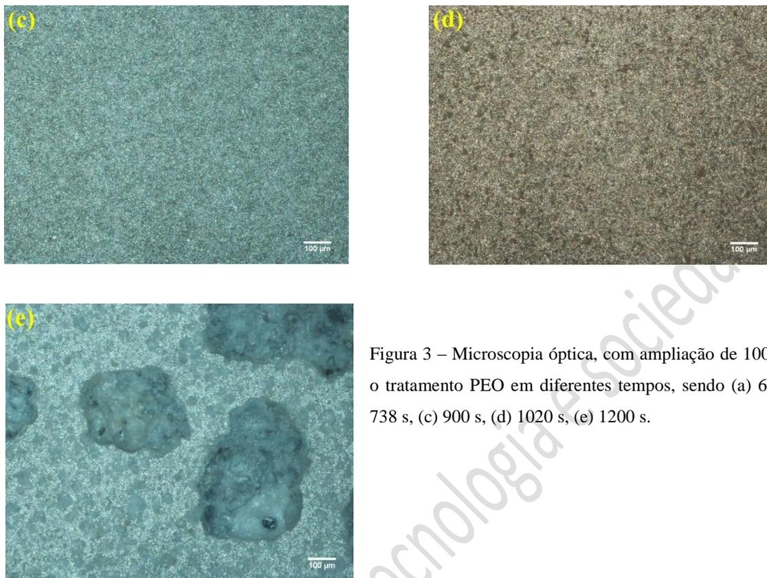
Figura 3 – Microscopia óptica, com ampliação de 1000x, após o tratamento PEO em diferentes tempos, sendo (a) 600 s, (b) 738 s, (c) 900 s, (d) 1020 s, (e) 1200 s.
