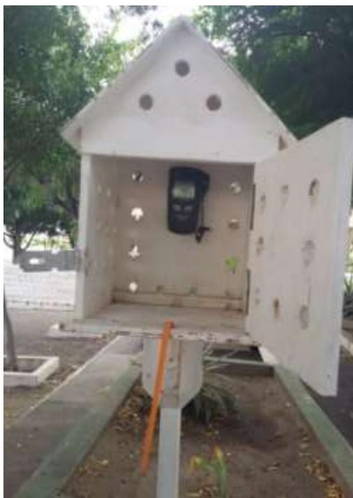
**Figura 05:** Aparelho datalogger de temperatura e umidade do ar acomodado no abrigo meteorológico.
