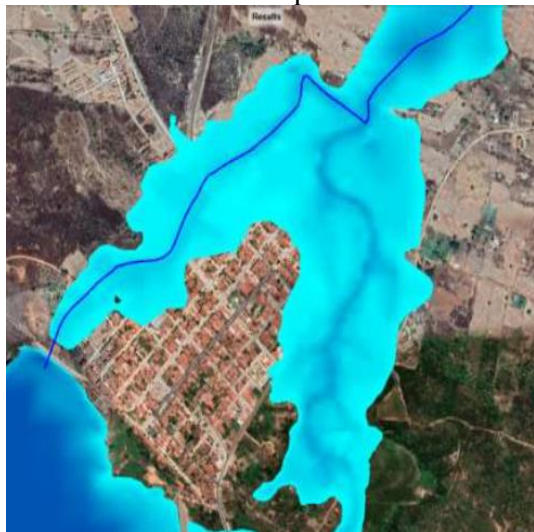
Figura 2: Simulação do percurso da água em caso de rompimento
